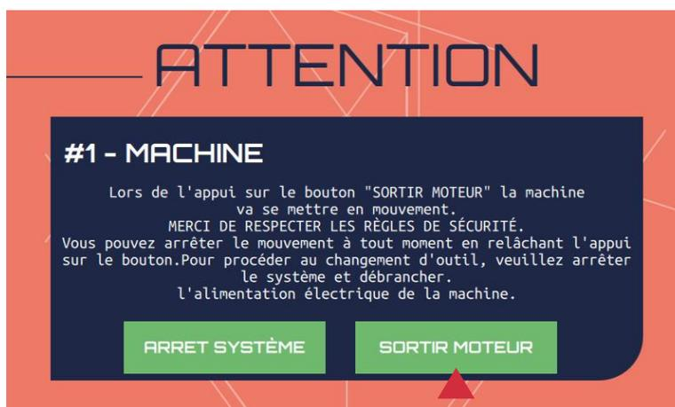
Une fois le moteur en position souhaitée, appuyez sur «Arrêt système» pour éteindre le système.
