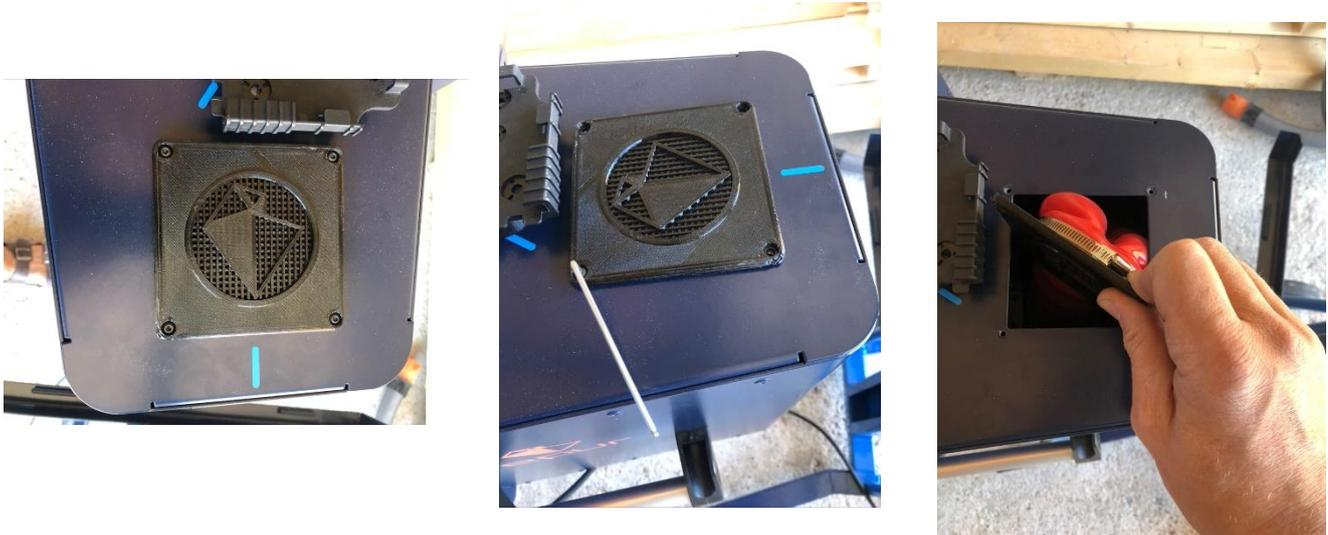
Dévissez les quatre vis d'assemblage du carter de l'interrupteur du moteur de broche.
