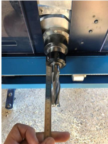
Une mauvaise mesure engendrera un usinage non conforme aux caractéristiques dimensionnelles que vous aurez entré.
