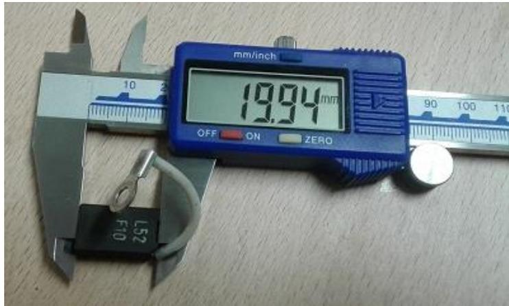
Un remplacement de ceux-ci est nécessaire si la cote restante du balai est inférieure à 10mm.
