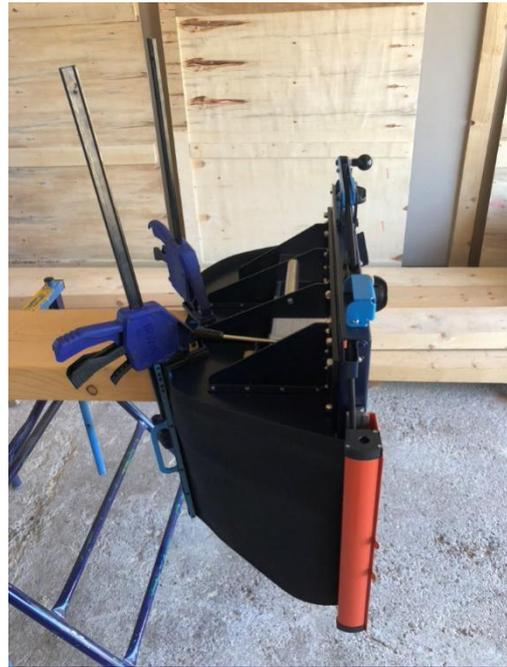
Utiliser le mécanisme de verrouillage sur la table de bridage
