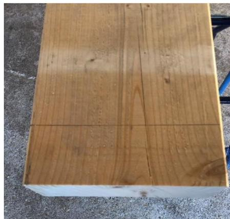
2. Tracez une parallèle au trait d'arase (distance indiquée par la machine suivant le type d'outil)
