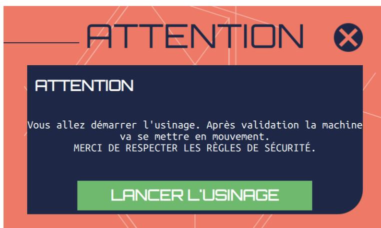
Le programme vous demande de valider le lancement de l'usinage. Si vous souhaitez annuler, appuyez sur la croix située en haut à droite de la fenêtre. Sinon si vous êtes certain de vouloir lancer l'usinage, de mettre la fraise en action et la machine en mouvement, appuyez sur **LANCER L'USINAGE**.
